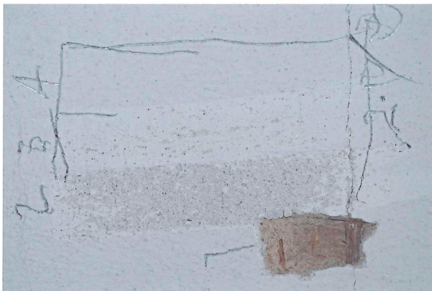
Sonda 2.10/2 na stropu – 1 rákosové pletivo a váp. omítka žlutého zabarvení, 2 štuková vrstva, 3-4 monochromní hlínková vrstva
